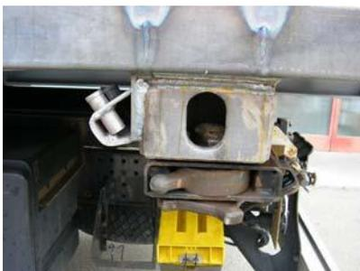
Plattform mit Standard Verriegelung, um die Maschine auf 3 oder 4 Achs LKW sicher zu verriegeln..
